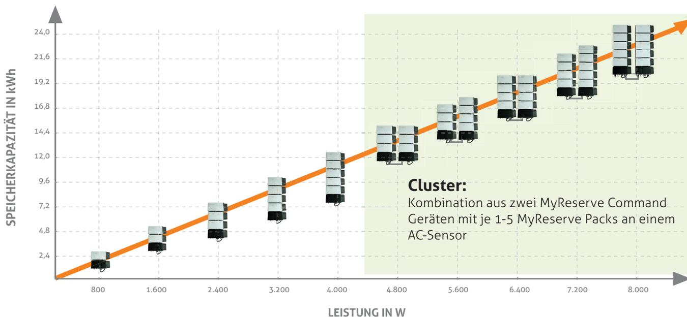
Hinweis zur Anlagenauslegung: Verwenden Sie zur Anlagenplanung immer den MyReserve String-Konfigurator. Der Konfigurator steht Ihnen im Pro-Bereich unserer Website [www.solarwatt.de](http://www.solarwatt.de) unter „Werkzeuge“ zur Verfügung.
